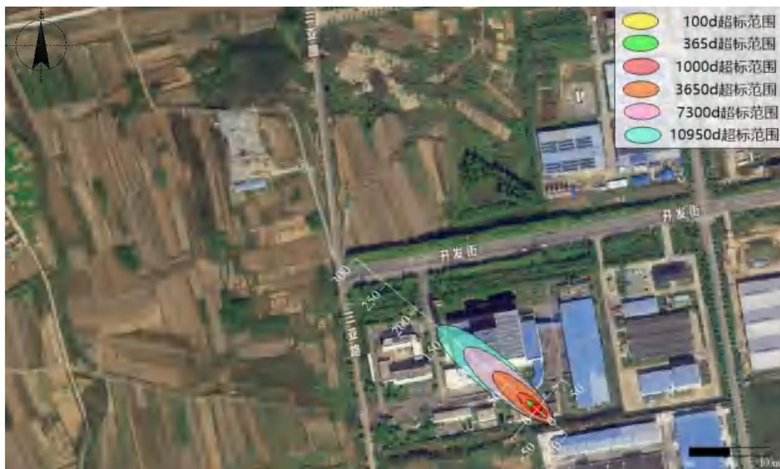
图 5.3-25 连续泄漏砷污染晕示意图
