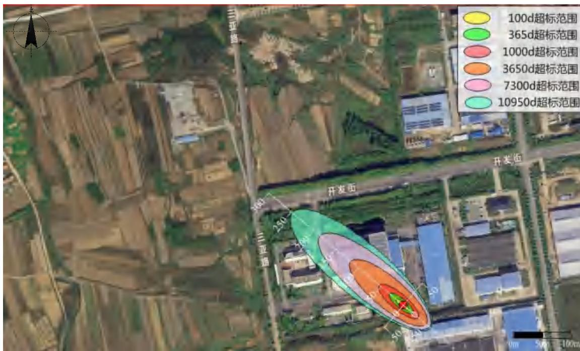
图 5.3-23 连续泄漏 COD 污染晕示意图
