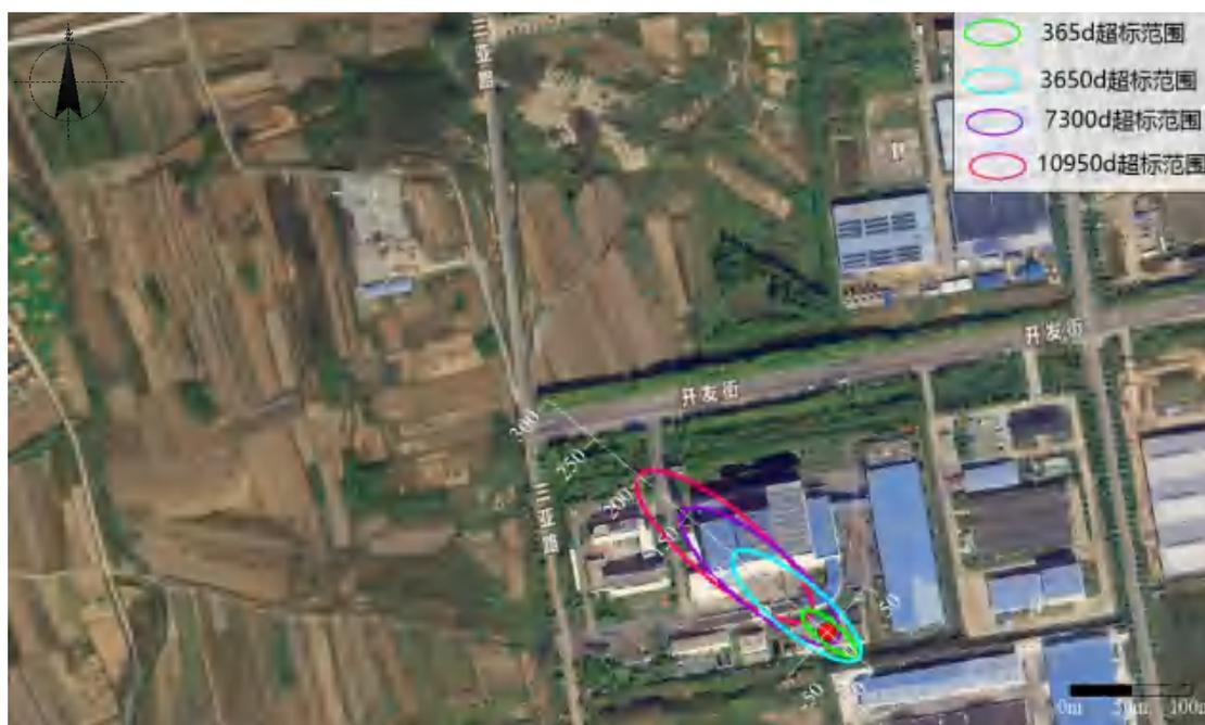
图 5.3-18 瞬时泄漏氨氮污染晕示意图
