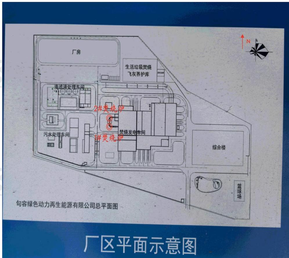
说明：◎焚烧炉废气采样点
