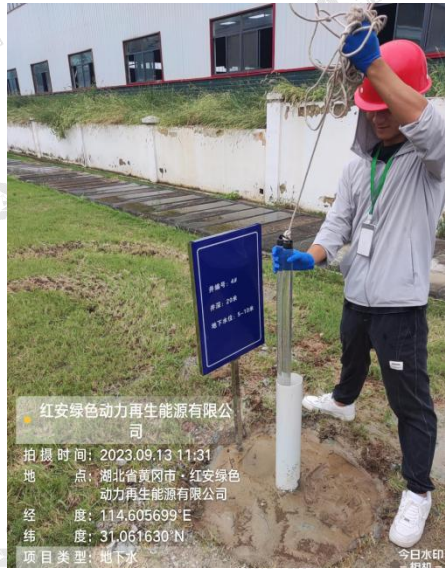
☆地下水采样点 - 4#
