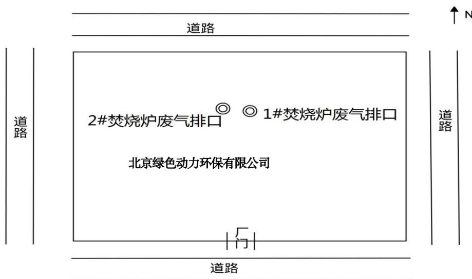
说明：◎焚烧炉废气采样点
