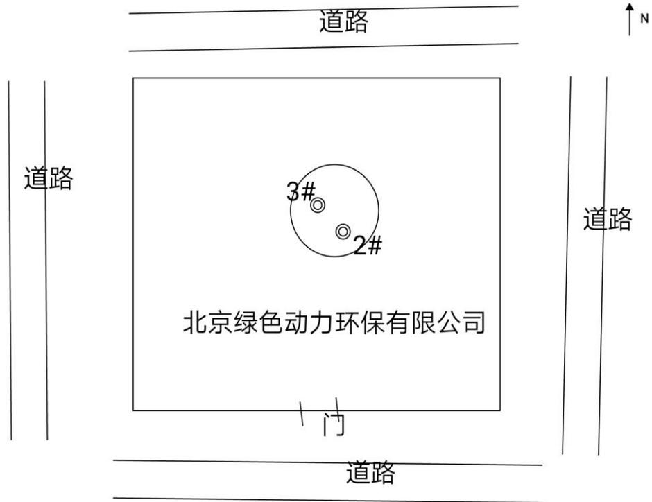
说明：◎焚烧炉废气采样点
