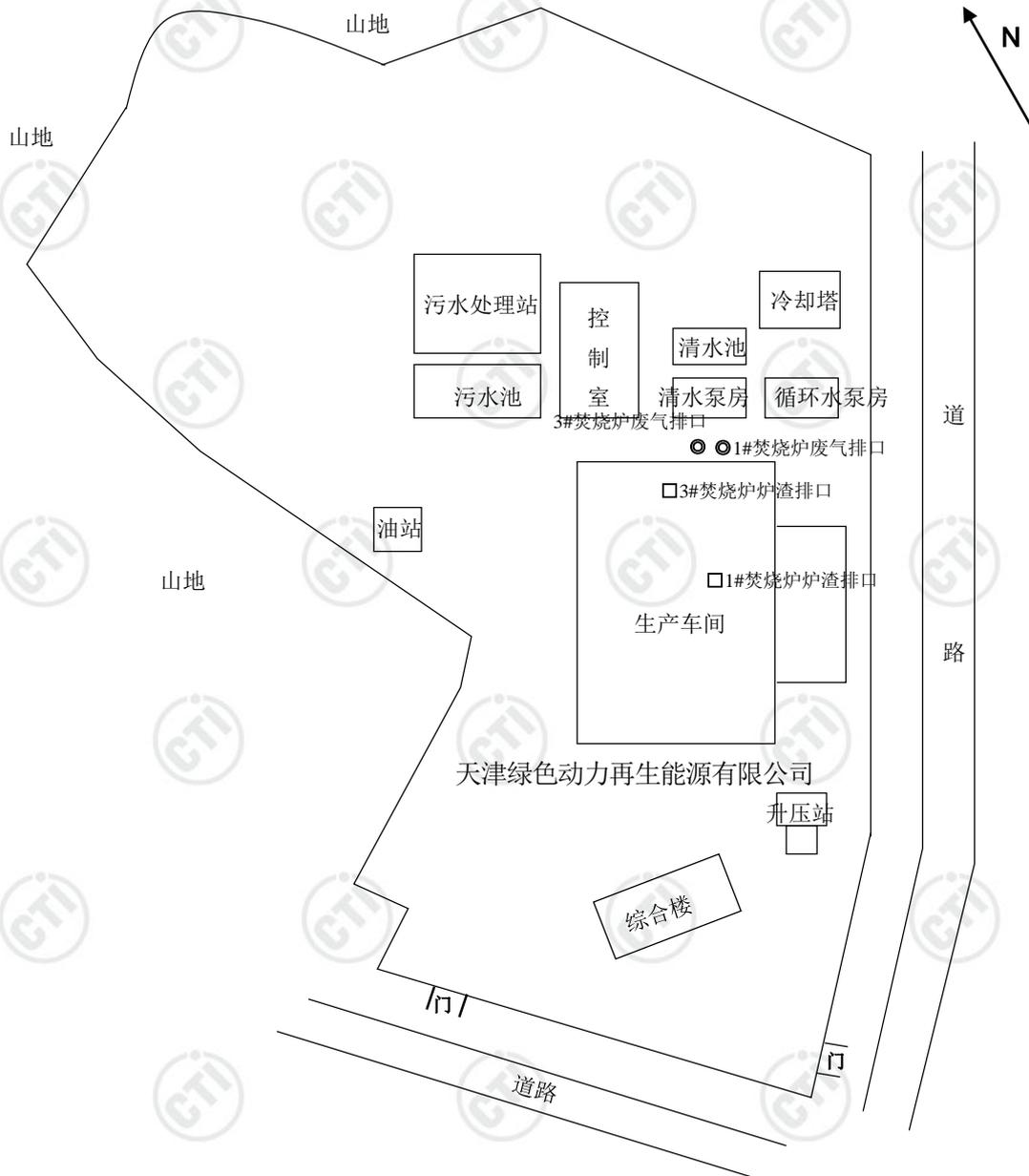
说明：◎焚烧炉废气检测点
