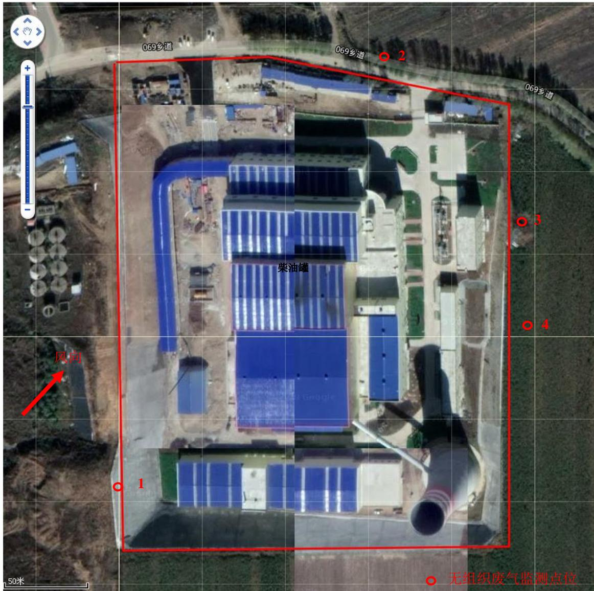
图 7.1-2 无组织废气监测布点示意图
