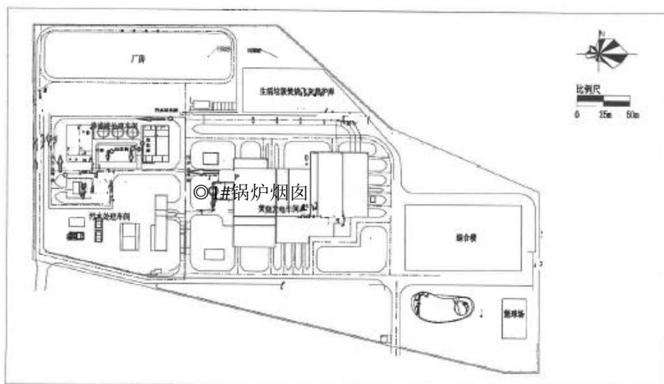
说明：◎焚烧炉废气采样点
